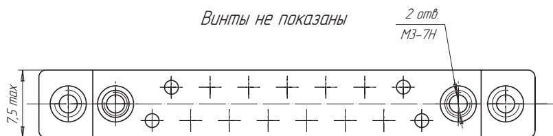
Разметка для крепления вилок РПМ8 с внутренней стороны стенки изделия
