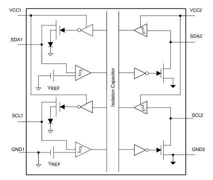
Figure 23. ISO1540 Block Diagram
