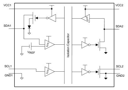
Figure 24. ISO1541 Block Diagram
