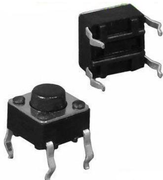
Тактовая кнопка RUiCHI KAN0611-0501B, 6x6x5 мм, OFF-(ON), 50 мА, 12 В, 100 МОм – это разновидность простейших механических выключателей, обеспечивающая замыкание контактов (без фиксации) только при наличии давления на поверхность штока (толкателя).
