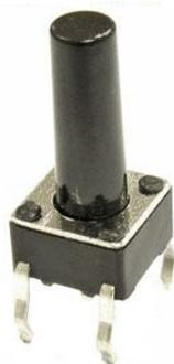
Тактовая кнопка RUiCHI KAN0611-1301B, 6x6x13 мм, OFF-(ON), 50 мА, 12 В, 100 МОм – это разновидность простейших механических выключателей, обеспечивающая замыкание контактов (без фиксации) только при наличии давления на поверхность штока (толкателя).
