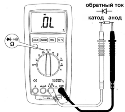
Рисунок 5. Проверка диодов
