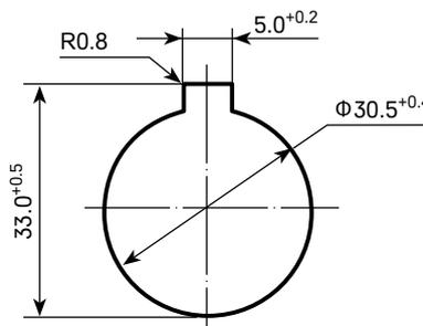
Установочные отверстия на панели для арматуры 02 габарита.
